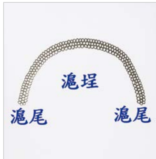
圖1 弧形石滬的頂視示意圖
