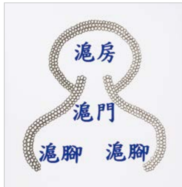
圖2 滬房石滬的頂視示意圖
